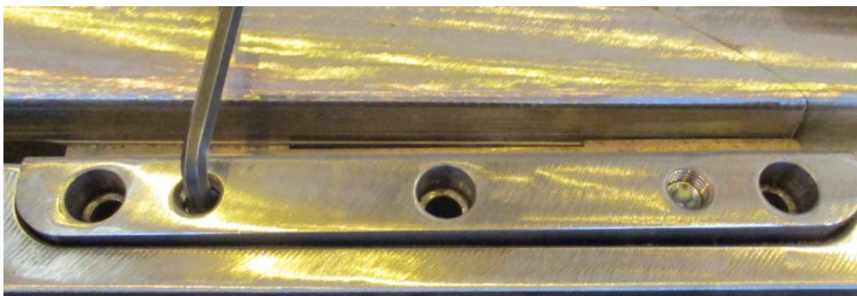
Střídavým a rovnoměrným utahováním stavěcích šroubů docílit vysunutí příchytky jazyka
