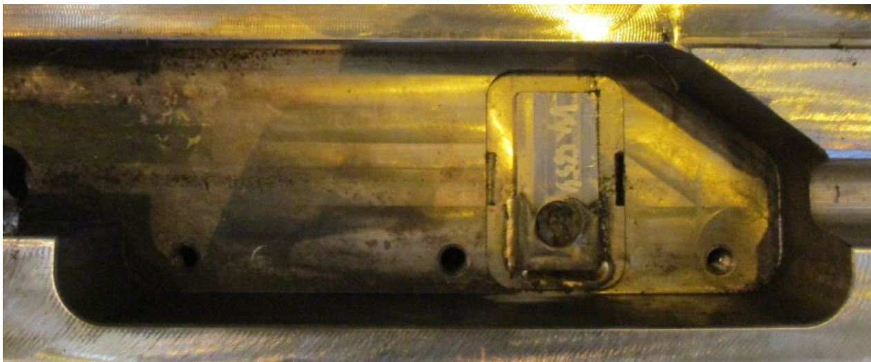
Před demontáží dvojdielného pojistného plechu zlehka poklepat
