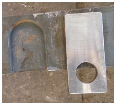
Horní část pojistného plechu s frézováním v patě kolejnice
