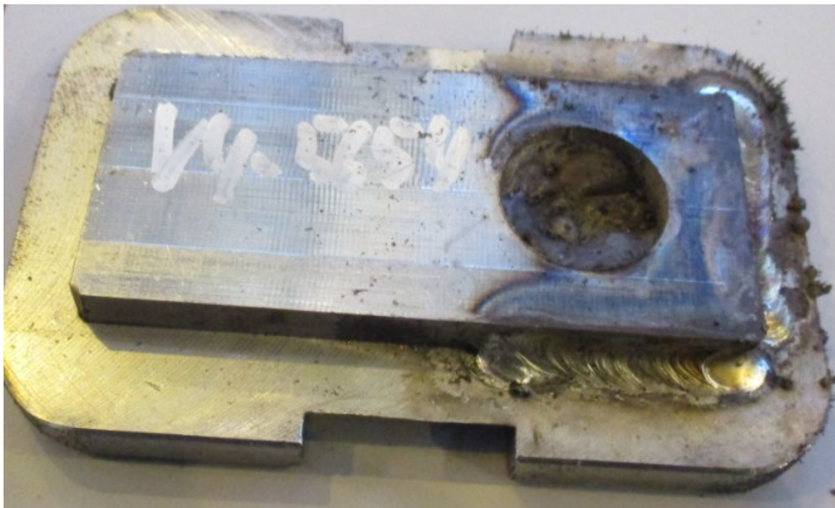
Demontovaný pojistný plech je svařencem dvou plechů
