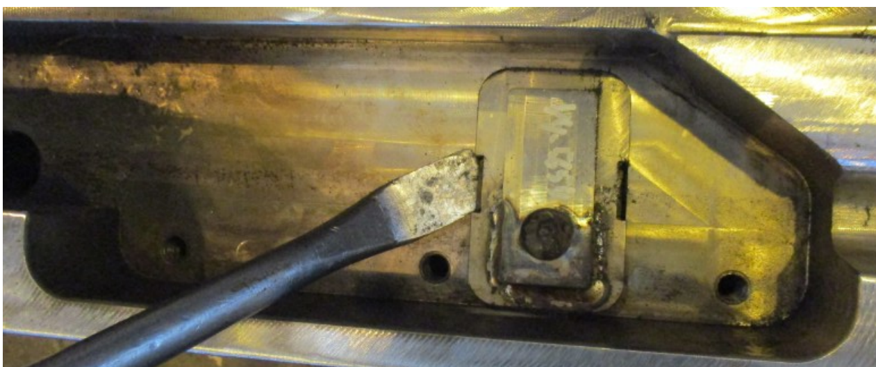
Do vybrání v pojistném plechu vsunout montážní páku a plech lehce nadzvednout střídavě na obou stranách
