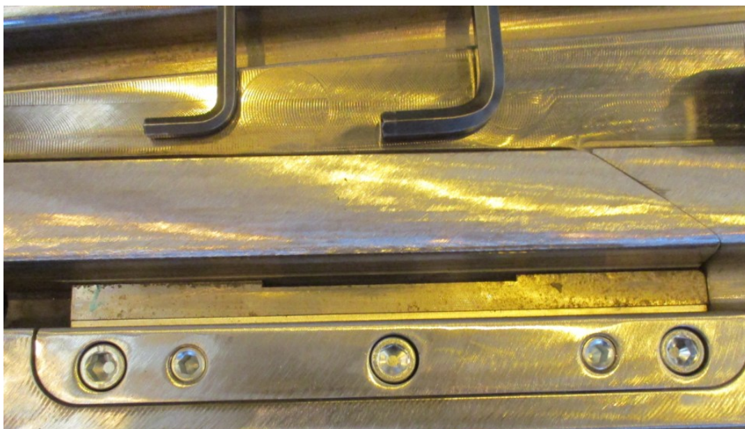
K demontáži příchytky k jazyku použít 2 imbusové klíče odpovídajících rozměrů
