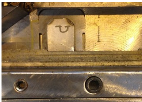
Pojistný plech se svíráním jazyka (1 půlka)
